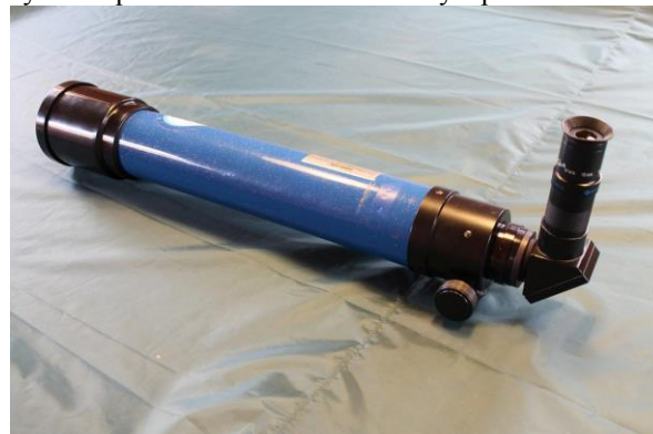
Рис. 3. Составной окуляр на базе ОКШ-15 на телескопе ТАЛ-75R
